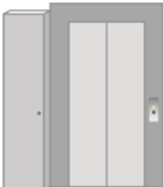
Telaio standard e armadio quadro di manovra
