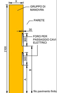
Le opere murarie della parete frontale al piano del gruppo di manovra vanno realizzate dopo il montaggio dell'impianto, della posa delle porte di piano e del gruppo di manovra.
