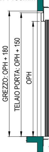
**SEZIONE VANO CORSA**
