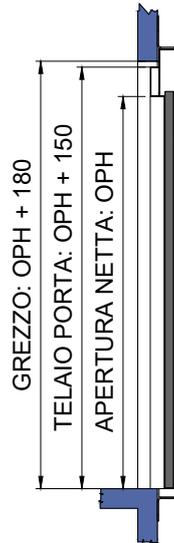
SEZIONE VANO CORSA
